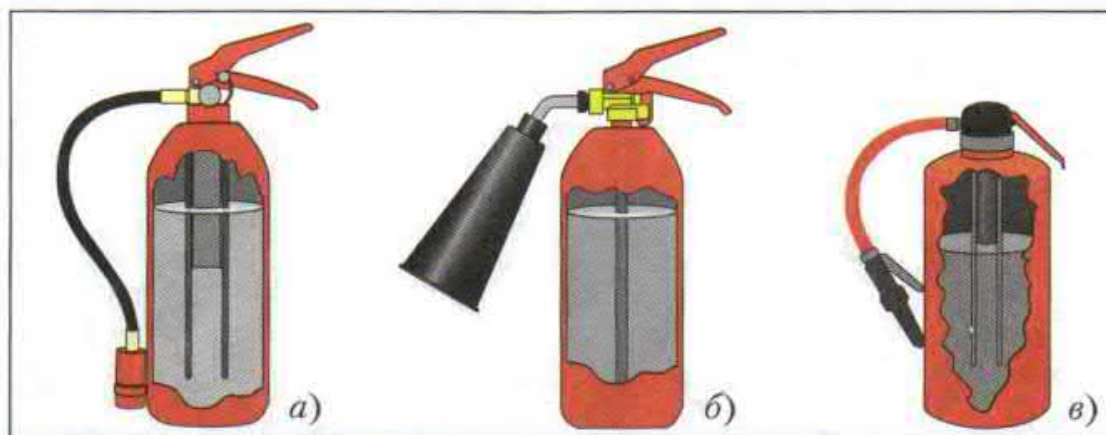
Огнетушители: а – воздушно-пенный; б – углекислотный; в – порошковый
