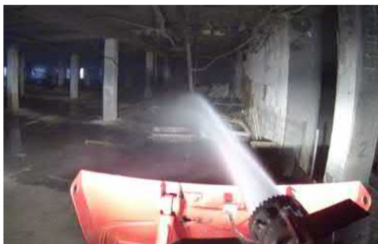
Рисунок 6. Тушение с применение РТК Ель-10 в дистанционном режиме на участке №4
