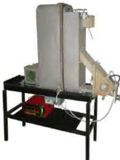
Рисунок 1. - Установка для определения токсичности строительных материалов
