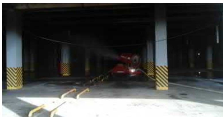
Рисунок 7. Тушение с применение РТК Луф-60 в дистанционном режиме на участке №4
